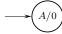
Figura 16.10: Evolução na construção do diagrama de estados do detector da sequência 0101, usando um modelo de Moore. Começa-se pelo estado inicial, designado arbitrariamente por estado A
